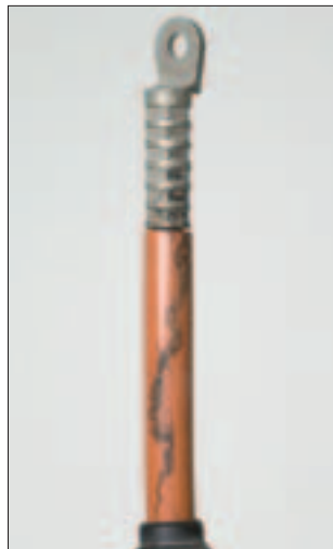
Образец, поврежденный трекинговой дорожкой
